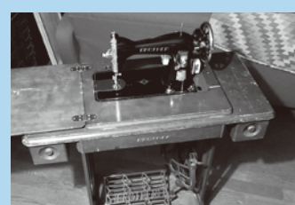
当時のミシンは、現在の電動式ミシンとは違い、勉強机ほどの大きさで、足の上下運動でミシン針を動かしながら縫い合わせるものでした。
